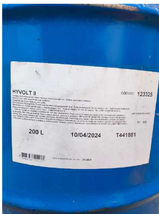
Figura 10: Óleo mineral isolante utilizado no enchimento parcial.
