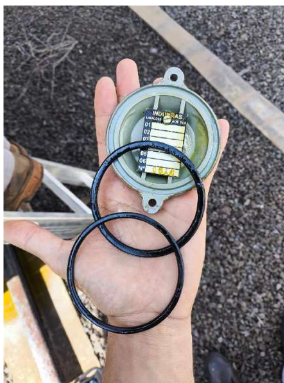
Figura 3: Vedações do sensor ressecadas e comprometidas.
