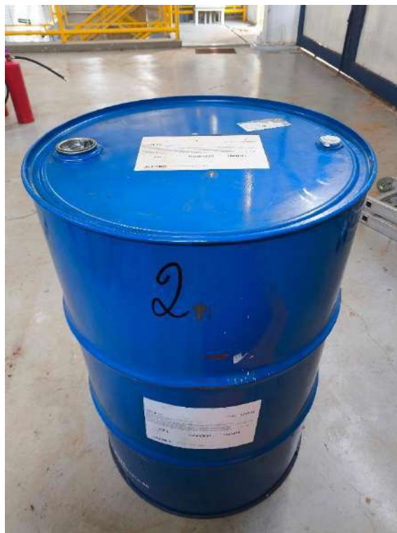
Figura 9: Óleo mineral isolante utilizado no enchimento parcial.
