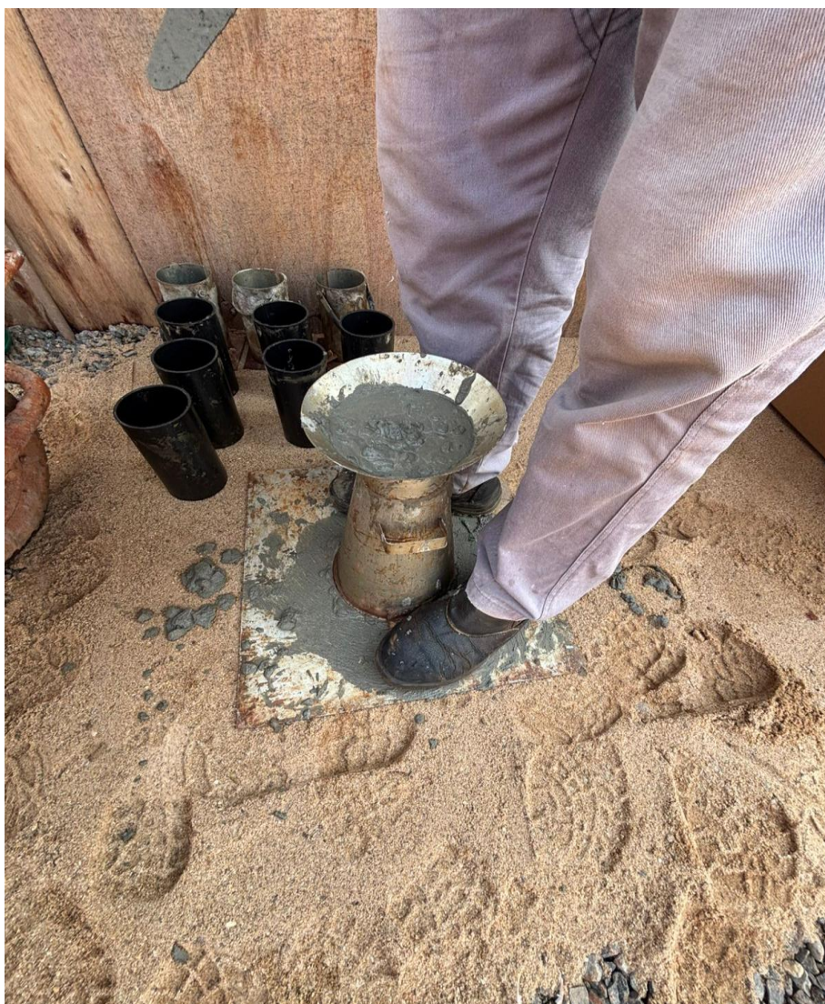
Ensaio de abatimento do tronco de cone (Slump Test), conforme ABNT NBR NM 67:1998
